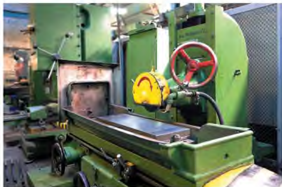
«Старожил» цеха №22 – плоскошлифовальный станок
